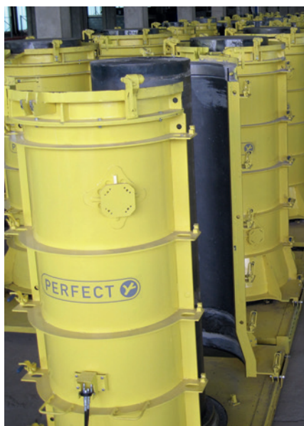
Формооснастка для серийного производства бетонных труб по технологии твердения в опалубке
